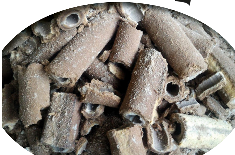
Tierras filtrantes una vez recuperado el aceite en el ciclo de filtración mediante el sistema de secado y autolimpiadas por el filtro.
