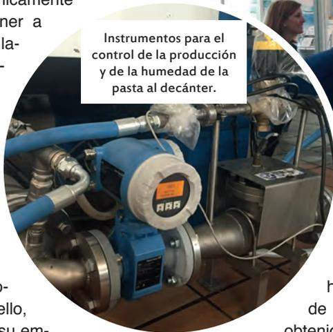
Instrumentos para el control de la producción y de la humedad de la pasta al decánter.
