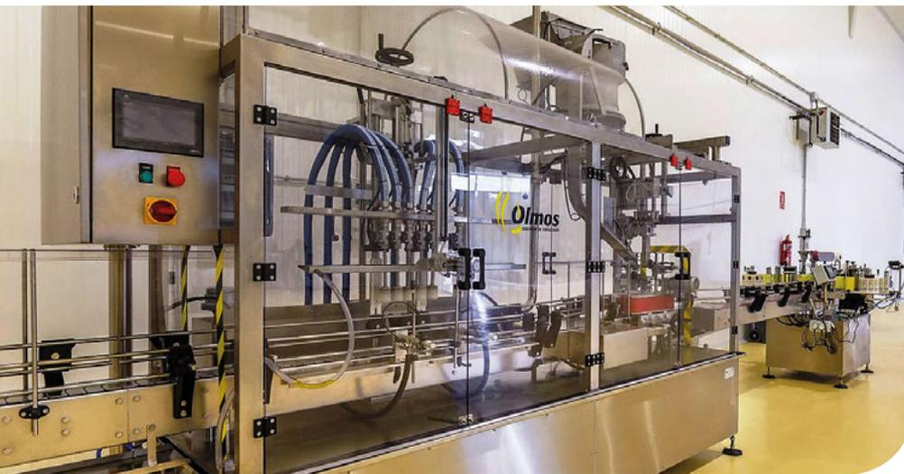
Monobloc de llenado y tapado COMPACT ECO 6S de Olmos, una máquina multiformato sin estrellas.
