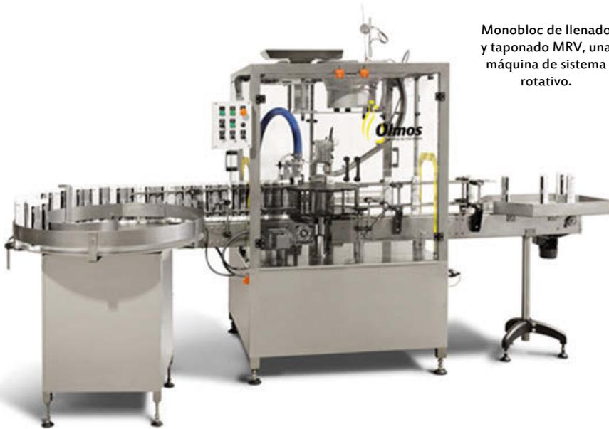
Monobloc de llenado y taponado MRV, una máquina de sistema rotativo.
